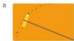
2) Gespannte Schnur an eine Ecke halten und einen Kreisbogen zeichnen
